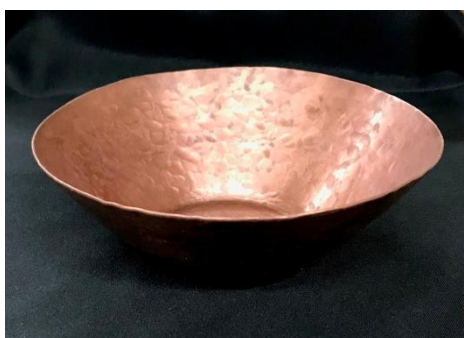
しぼり (焼きなまして金属を柔らかくし、槌でたたいて成形する)
